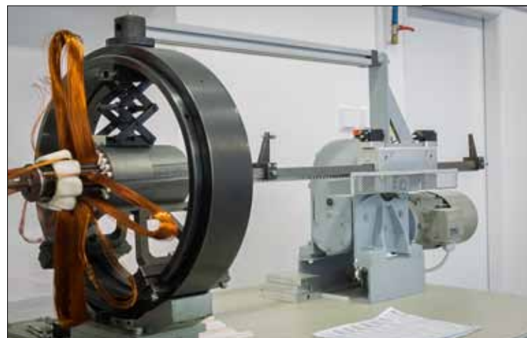
Obr. 3. Stator upnutý do otočného kruhu s cívkami připravenými ke vtažení
